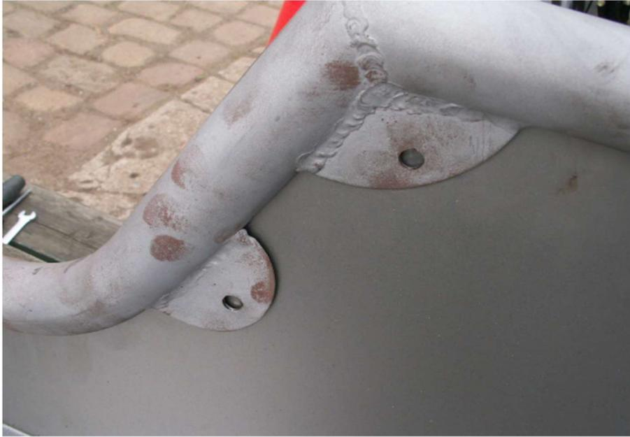
Nun wird das geschlitzte Rahmenrohr aufgesetzt (ACHTUNG: Bitte sicherstellen, dass das Blech in der Mitte dieser Bleche sitzt (Bild oben; also zwischen dem inneren und dem äußeren Blech)).
