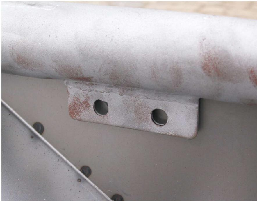
Jetzt dort, wo keine Löcher im Reparaturblech vorhanden sind, entsprechende Löcher bohren und Teile verschrauben, z.B. HIER.
