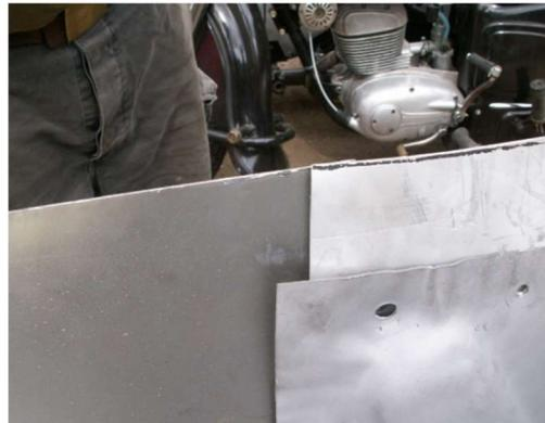
Da die Karossen wie schon erwähnt sehr unterschiedlich gefertigt wurden (Toleranzen), muss das Blech am Berührungspunkt der beiden Teile links und rechts oben evtl. in der Höhe angepasst werden. Im rechten Bild ist das Blech schon angepasst(hier auf der rechten Seite des Bootes zu sehen)
