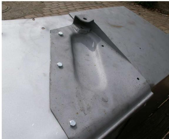
Dann werden die beiden Teile der Karosse mittels der Verstärkungsbleche lose miteinander verbunden. **SCHRAUBEN BITTE NOCH NICHT FESTZIEHEN!**
